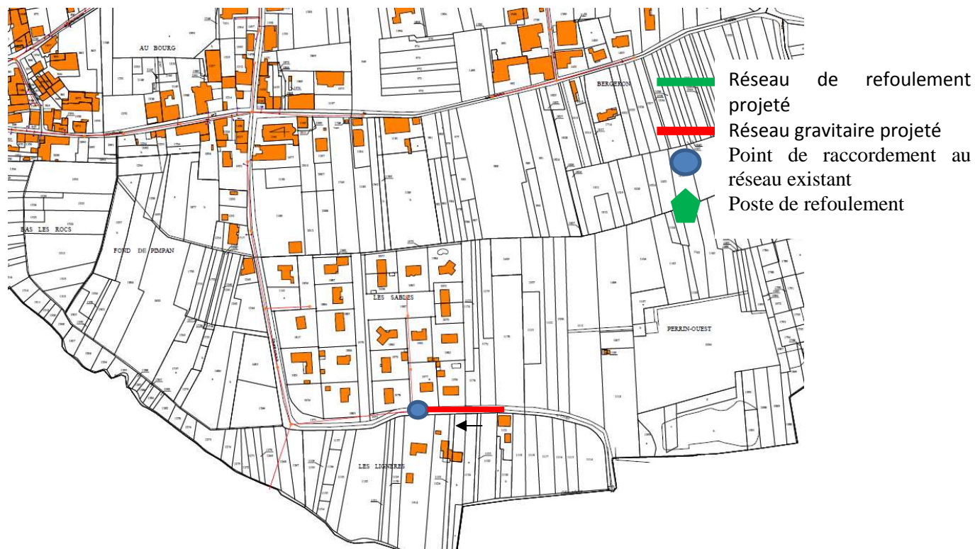
Figure 4 : Tracé possible pour l'assainissement collectif
